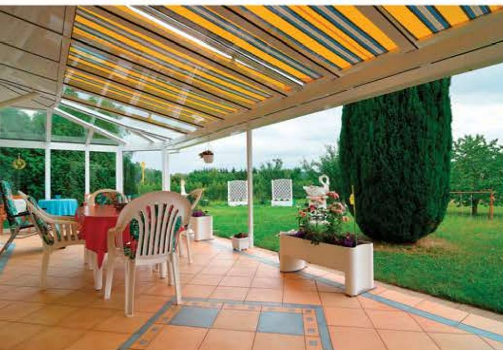
Sisteme moderne de umbrire pot fi atașate teraselor acoperite de sticlă. Pentru ca lumina și căldura să nu ne deranjeze se pot folosi marchize montate sub sticlă. Aceste marchize pot fi acționate manual sau pot fi cu motor și telecomandă.
